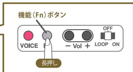
本体背面の機能 (Fn) ボタンの長押しで、SDカード内のフォルダを切り替えます。
