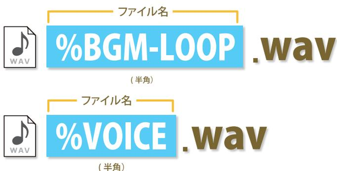
同一ディレクトリ内に音声ファイル名「%BGM-LOOP.wav」と「%VOICE.wav」(すべて半角)がある場合、BGM ループモードとしてボイスミックス再生をします。
