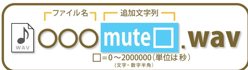
音声ファイルを再生した直後のインターバル時間（無音時間）を設定します。
